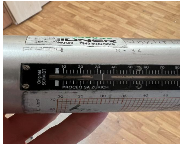
16 pav. Nustatytas denginiui panaudotos plokštės betono stipris
